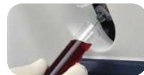
Las muestras se pueden aspirar directamente de los tubos, eliminando la transferencia a una jeringa o a un tubo capilar.
