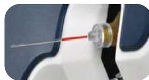
El muestreo capilar se puede llevar a cabo sin adaptadores.
