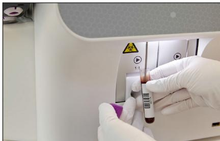
Ilustración 32: Aspiración de la muestra
