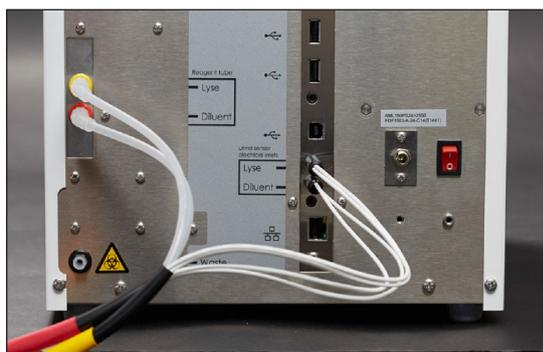
Ilustración 14: Conexión de reactivos
