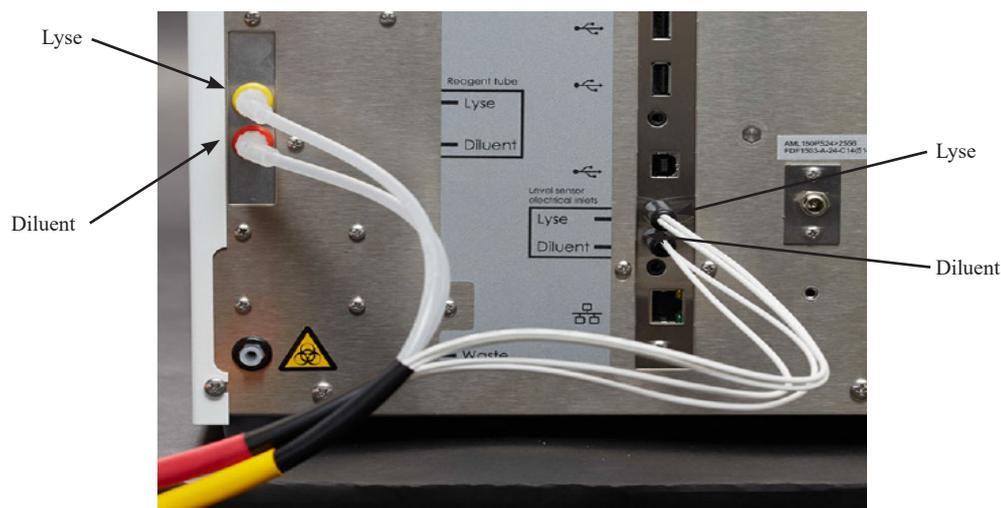
Ilustración 18: Instalación de los tubos de reactivo
