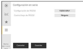
Ilustración 109: Configuración en serie
