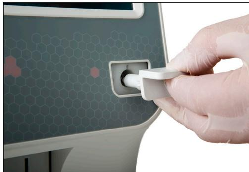
Ilustración 34: Inserción del MPA en el analizador
