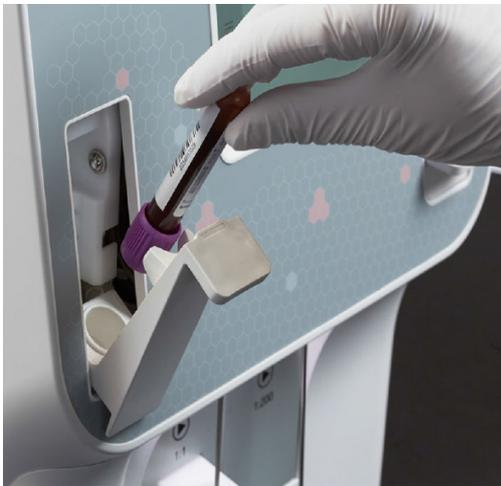
Ilustración 35: Inserción del tubo de muestra
