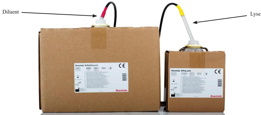
Ilustración 19: Instalación de los tubos de reactivo
