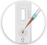
2. Añada 5ul de muestra de sangre con pipeta a el área superior (cercana a la ventana de prueba) del pocillo de muestra del dispositivo (sostenga la pipeta verticalmente y gentilmente toque el extremo contra la almohadilla dentro del pocillo de muestra para transferir).
